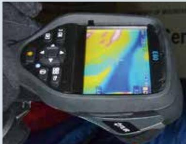
**Spurensuche: Die Wärmebildkamera zeigt alle schwach isolierten Bereiche.**
