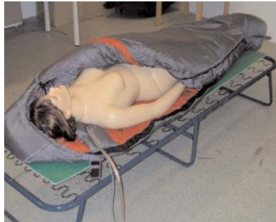
Testanordnung mit der Wärmetestpuppe "Louise"
